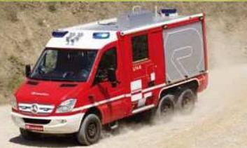
Les points de fixation pour carrosseries sont les mêmes que sur les Sprinters de série. Ainsi il est possible de monter sur Sprinter 6x6 toute carrosserie déjà existante sur modèles de série.
